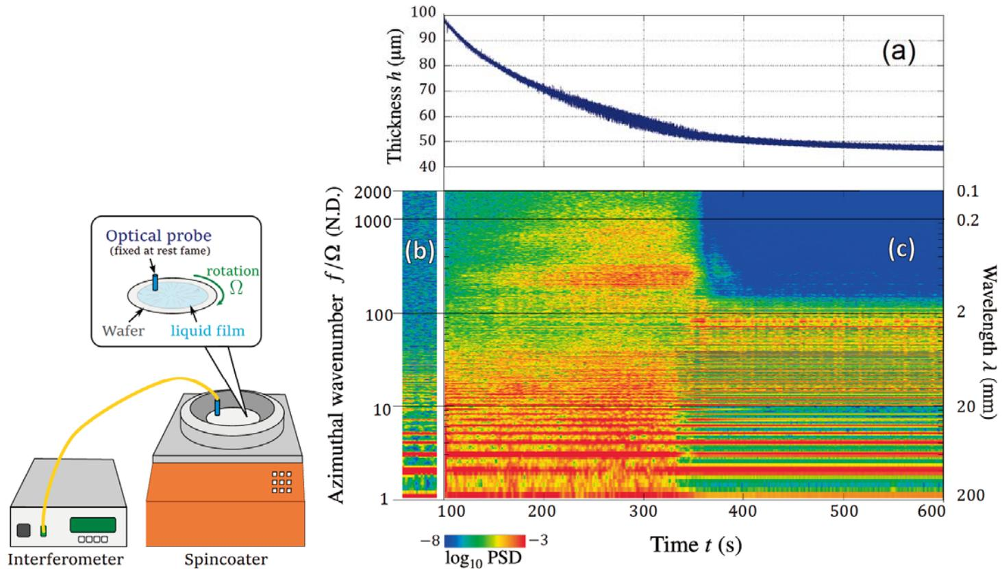
図6 スピンコート中の膜厚の時空間変動<sup>1)</sup>。エポキシ樹脂とキシレンから成る塗布溶液をシリコン基板上で回転数 $\Omega = 50\text{rpm}$ にてスピンコート中に干渉膜厚計にて測定したもの。(a) 膜厚の時間変化、(b) 基板のみを回転させた場合の反射光強度の時間周波数スペクトル、(c) 膜厚変化 (a) の時間周波数スペクトル。横軸は時間 $t$ 、左縦軸は回転周波数で規格化した空間周波数であり、一回転に含まれる波数に相当する。右縦軸は対応する空間波長。カラーコンターは膜厚を対数スケールで示したもの
