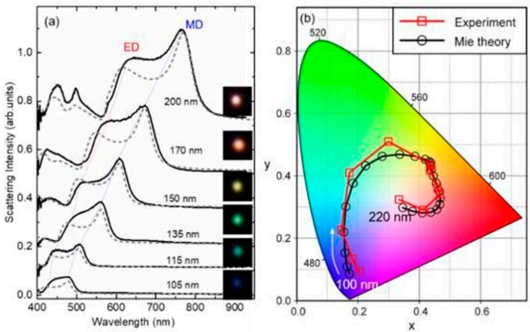
図4.(a)単一シリコンナノ粒子の後方散乱スペクトルと散乱イメージ、(b)散乱スペクトルから求めた単一シリコンナノ粒子の色空間の実験・計算結果<sup>4)</sup>
