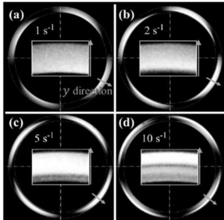
図5 ひも状ミセル水溶液の同心二重円筒型流路内流れの流動複屈折分布の可視化例2).
