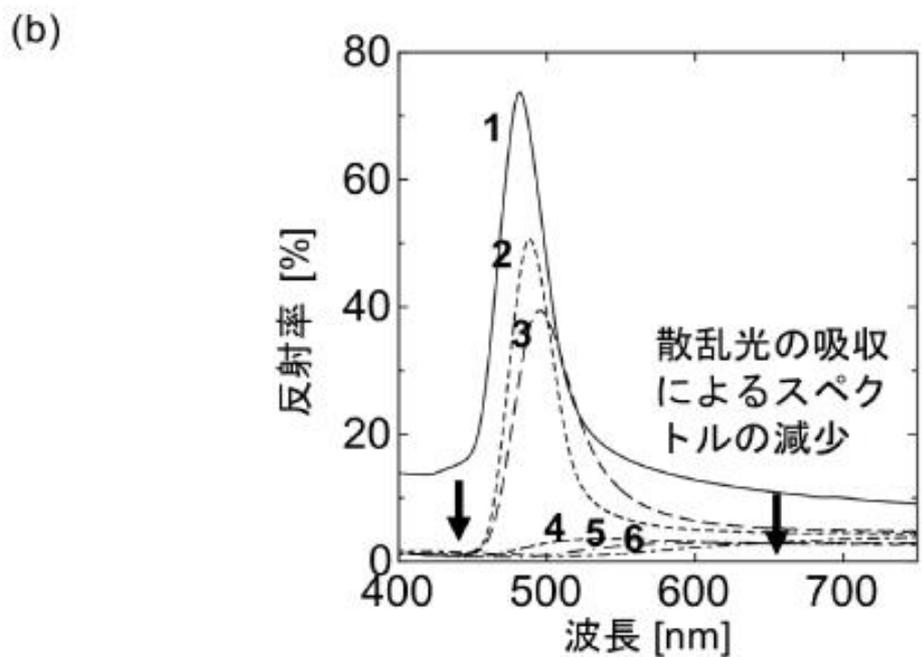
図 1 (a)メラニン模倣粒子を用いて作製した固体ペレット材料の写真, (b)反射スペクトル測定結果
