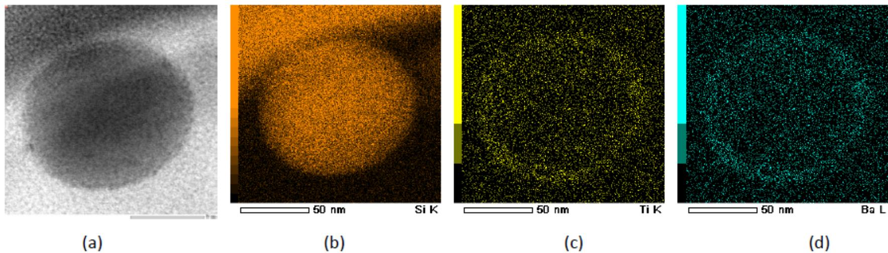
図8 作製したBaTiO<sub>3</sub>-SiO<sub>2</sub>粒子のEDSによる元素マッピング像(a) 明視野像、(b) Si元素位置、(c) Ti元素位置
